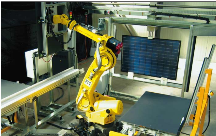
Bild 1: Produktionszelle für das Modultrimmen
